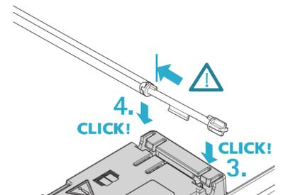
Assembler vos adaptateurs pour synchronisation avec la barre prévue à cet effet et clipser vos adaptateurs au boîtier Push To Open.
